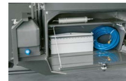
Réservoir de 20 l d'eau et distributeur de savon pour se laver les mains une fois le travail terminé
