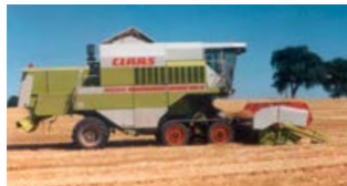
CLAAS startet TERRA TRAC Versuche an einem MEGA Mähdrescher. Die Laufräder sind luftbereit.
