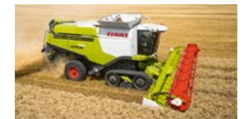
Die neue hydropneumatische Federung ermöglicht einen hohen Fahrkomfort auf dem Feld und auf der Straße. Dieses Laufwerk wird bis heute verbaut.
