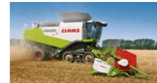
Das TERRA TRAC Raupenlaufwerk profitiert nun von einer deutlichen Strukturverstärkung durch einen einteiligen, gegossenen Rahmen, um so den höheren Maschinengewichten gerecht zu werden.
