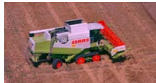
Die erste Serie des TERRA TRAC Laufwerks an einem LEXION 450. Damals noch mit starrer Anbindung an die Achse. Die Laufräder sind aus Stahl mit aufgeschraubten Gummielementen, um den hohen Reibbelastungen standhalten zu können.
