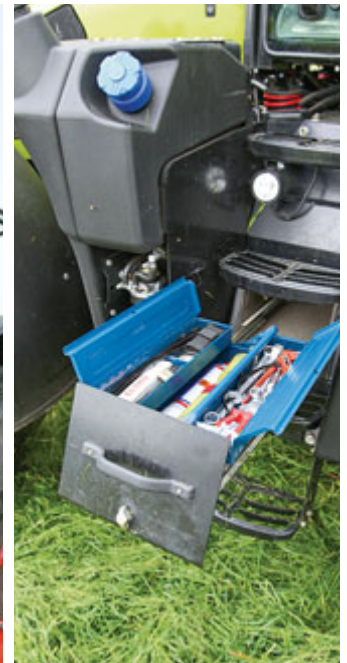
Der AdBlue-Tank fasst 42 l und ist in den 500 l großen Dieseltank eingebettet. Eine tolle Idee ist die Schublade für eine genormte Werkzeugkiste!
