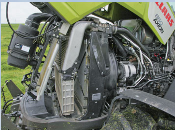
Unter der Haube sitzt jetzt statt „Deere Power Systems“ ein Aggregat von „Fiat Powertrain Technologies“, das bereits die Abgasstufe IV erfüllt. Aus den 6,7 l Hubraum kommen bis zu 264 PS – immer!
