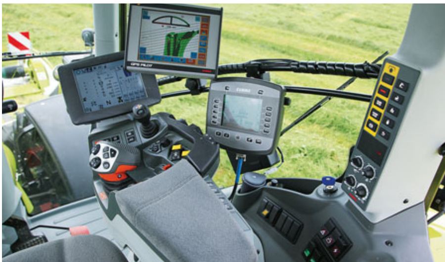
Bei der „Cebis“-Ausstattung gibt es – wie bei der zukünftig auch lieferbaren stufenlosen „Cmatic“-Variante – die neue Bedienarmlehne mit dem „Cmotion“-Fahrhebel und acht frei belegbaren „F“-Tasten. ISO-Bus-Geräte und die GPS-Lenkung haben aber nach wie vor ein separates Terminal.
