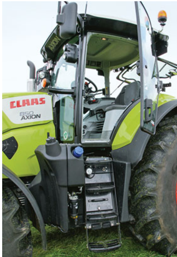
Der AdBlue-Tank fasst 42 l und ist in den 500 l großen Dieseltank eingebettet. Eine tolle Idee ist die Schublade für eine genormte Werkzeugkiste!
