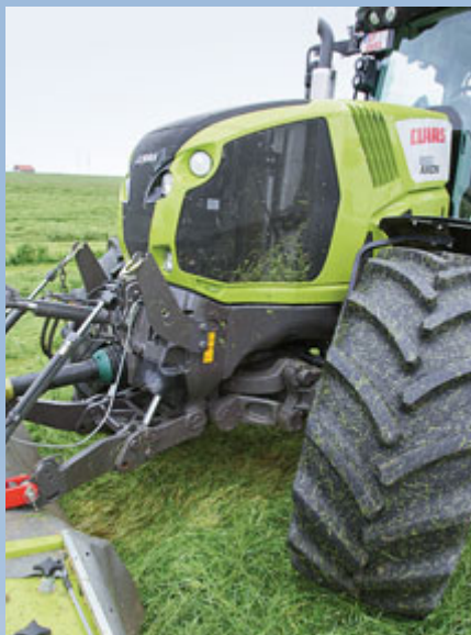
Die Vorderachse gibt es wahlweise gefedert, das Fronthubwerk ist sehr gut integriert.
