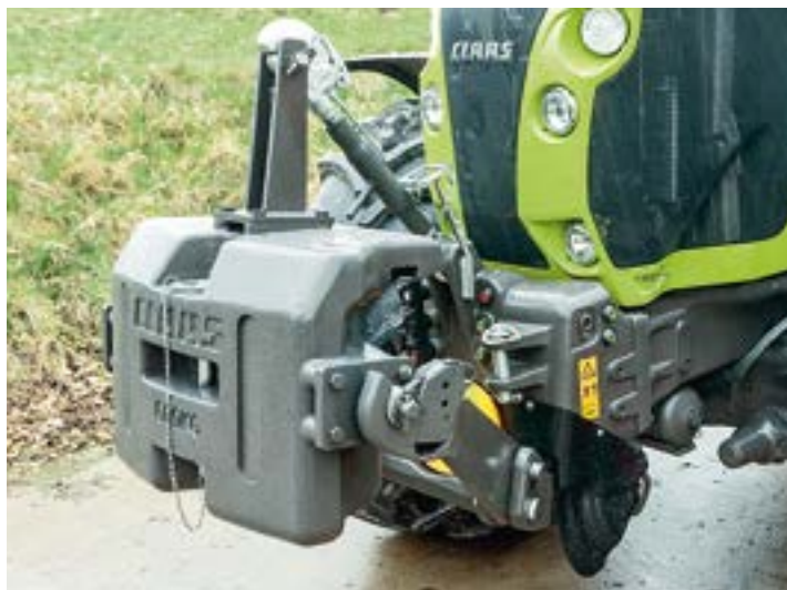
Das Fronthubwerk ist schön integriert und mit zwei Zylindervarianten lieferbar. Es gibt auch vorne eine Bedienung fürs Steuerventil und die Zapfwelle!
