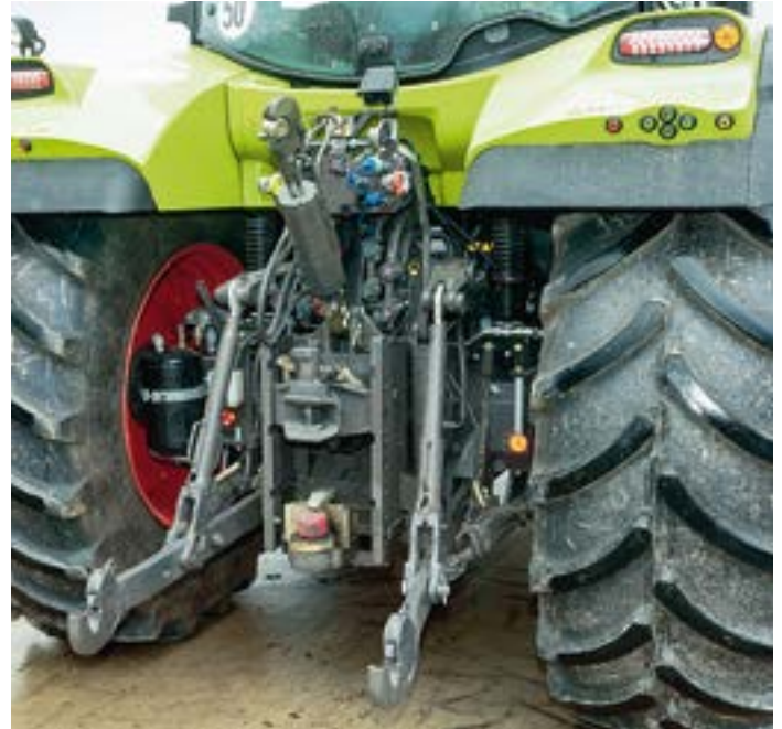
Hubkraft und Hydraulikleistung könnten größer sein, Hubgestänge, Ölschlüsse und die externe Bedienung auf beiden Kotflügeln sind super. Die Knöpfe sind gut erreichbar und eindeutig beschriftet.
