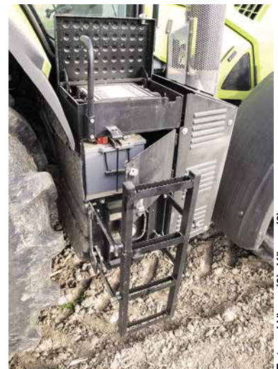
Hinter dem rechten Aufstieg sind E-Box und Batterie platziert.
