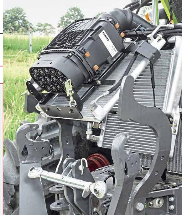
Der FPT-Vierzylinder mit 4,5 l Hubraum läuft sparsam und erfüllt die Abgasstufe IV. Auch die Leistung passt. Fotos: Tovornik, Wilmer
