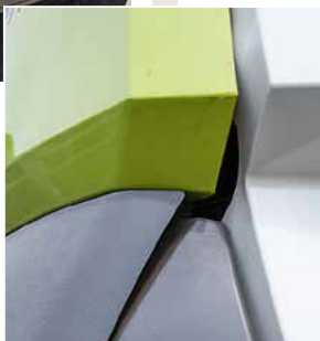
Die Motorhitze kann bei älteren Modellen nicht immer problemlos entweichen. Dadurch sind die Kunststoffklappen bereits verzogen (rechts). Claas die Luftzufuhr bei den neuen Modellen optimiert.
