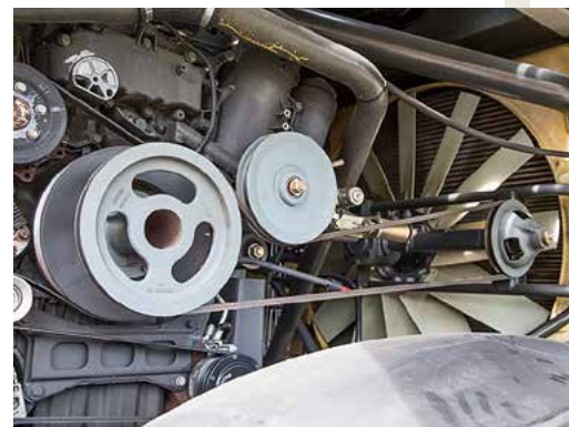
Der Riemen für den Lüfterantrieb ist relativ lang. Die Spannvorrichtung und der Sitz sind deshalb genau zu inspizieren.
