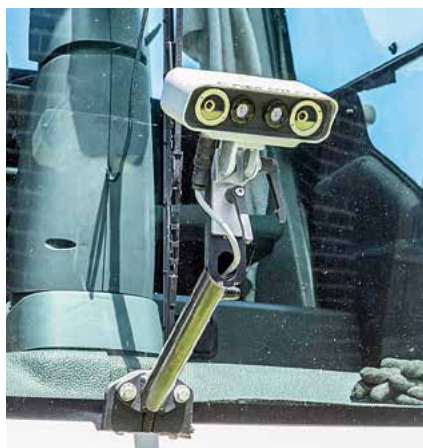
Wenige Modelle sind mit dem Cam-Pilot ausgerüstet. Besitzer schwören auf diese Technik. Sinnvoll, wenn viel Gras gehäckselt wird.
