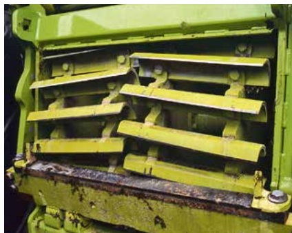
Die Vorpressung mit vier Vorpresswalzen hat Claas nicht verändert. Aber die Dämpfung mit Hydraulikzylinder mit zusätzlichem Zugzylinder anstelle eines mechanischen Dämpfers ist gerade im Gras zu empfehlen. Der Antrieb für die Vorsätze ist bei größeren Antrieben dreirillig ausgeführt.
