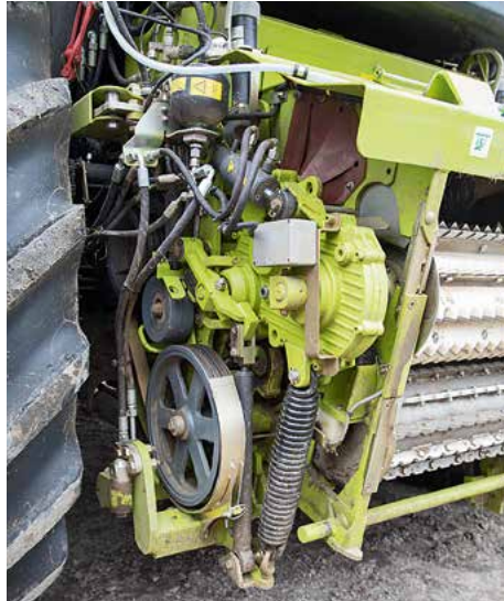
Die Vorpressung mit vier Vorpresswalzen hat Claas nicht verändert. Aber die Dämpfung mit Hydraulikzylinder mit zusätzlichem Zugzylinder anstelle eines mechanischen Dämpfers ist gerade im Gras zu empfehlen. Der Antrieb für die Vorsätze ist bei größeren Antrieben dreirillig ausgeführt.
