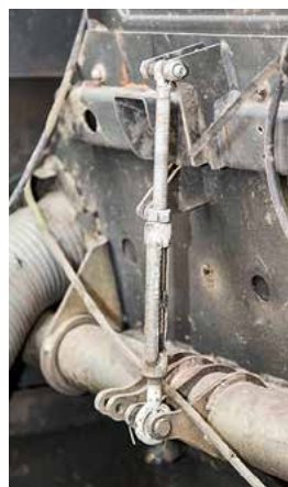
Die Linearmotoren zur Verstellung des Spalts an der Gebläserückwand versagen schon mal. Es geht auch mit einer einfachen Spindel, dann aber ohne Verstellung.
