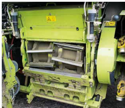
Die V-Max-Trommel war zunächst offen (oben). Mittlerweile sind die Trommeln geschlossen. Mit Sternsegmenten werden die bis zu 36 Messer gehalten. Es gibt Trommeln mit 20 bis 36 Messern. Fotos: Bensing, Touvornik (3)
