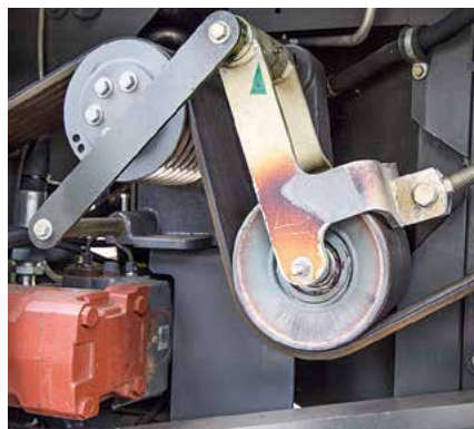
Eine zu heiße Spannrolle spricht für einen heißen Einsatz... Bei den neuen Modellen wird das Powerband hydraulisch gespannt.
