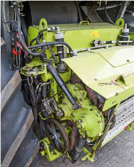
Die Vorpressung mit vier Vorpresswalzen hat Claas nicht verändert. Aber die Dämpfung mit Hydraulikzylinder mit zusätzlichem Zugzylinder anstelle eines mechanischen Dämpfers ist gerade im Gras zu empfehlen. Der Antrieb für die Vorsätze ist bei größeren Antrieben dreirillig ausgeführt.
