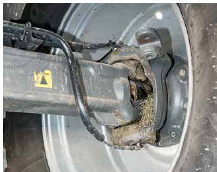
Beim Typ 494 sollten Sie sich unbedingt die Achsschenkel und den Mittelachsbolzen der Hinterachse genauer anschauen.
