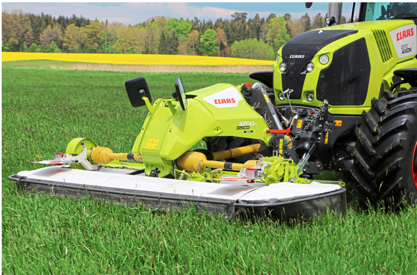
Der Kraftfluss im Move-Mähwerk verläuft sehr gradlinig vom Traktor über das Winkelgetriebe zu den Mähscheiben und zum Aufbereiter.
