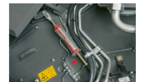
Alle Schmierpunkte sind zu zentralen Schmierleisten zusammengefasst und klar markiert.
