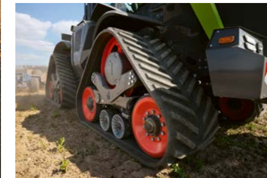
◀ Zwei Laufbandbreiten (914 mm oder 762 mm) garantieren maximale Bodenschonung. Mit den schmalen Laufbändern bleibt der XERION unter 3 m Breite.
