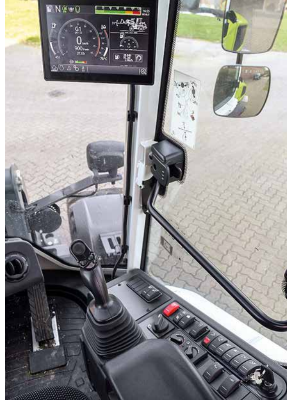
△ Der Joystick hat einen kleinen Daumen-Kreuzhebel für den Teleskopauschub und die dritte Funktion.
