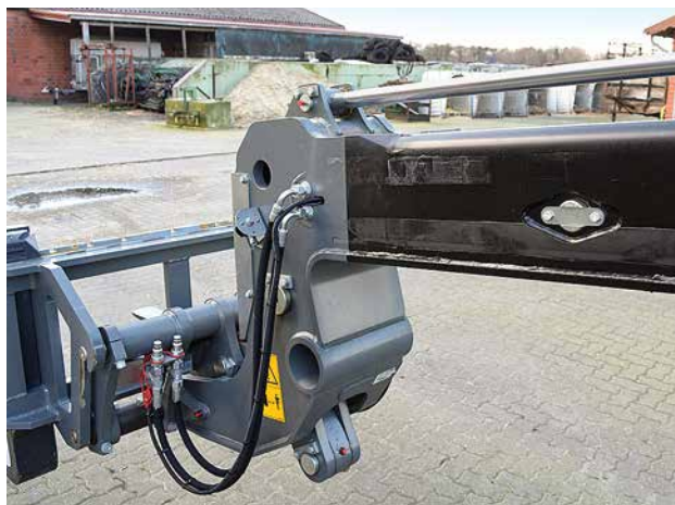
▷ Der im Arm liegende Werkzeugzylinder kippt die Aufnahme über eine Z-Kinematik.
