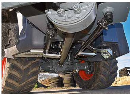
△ Ein Lenkgestänge überträgt den Lenkeinschlag vom Vorderwagen auf die Achsschenkel.
