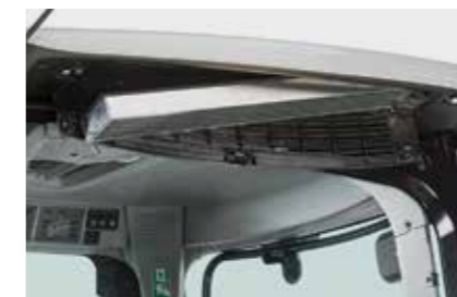
Le filtre à air de la cabine est facilement accessible sur le toit de la cabine.
