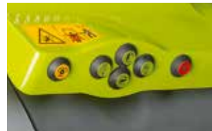
Commandes externes pour le relevage arrière, la prise de force et un distributeur librement sélectionnable.
