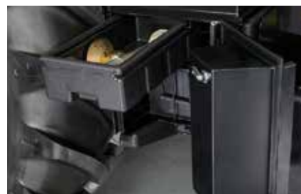
La batterie et un compartiment de rangement pour les outils sont situés dans les marches d'accès sur le côté droit.
