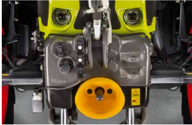
Le relevage avant est équipé de raccords pour un distributeur et d'une conduite de retour à écoulement libre.
