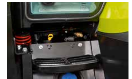
Le raccord d'air comprimé se trouve sur le côté gauche des marches d'accès.
