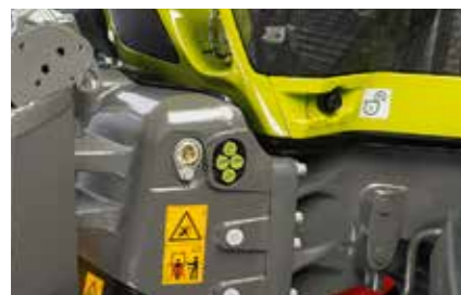
Commandes externes pour le relevage avant et un distributeur (en fonction de l'équipement installé).
