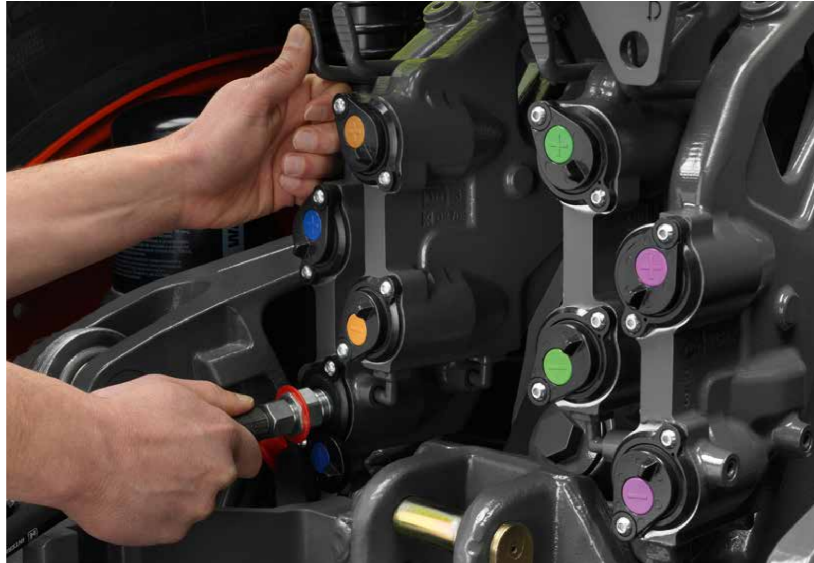
Le relevage avant est équipé de raccords pour un distributeur et d'une conduite de retour à écoulement libre.
