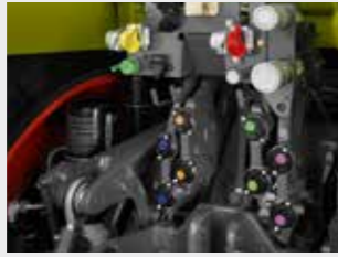
Freins à air comprimé avec dessiccateur d'air.
