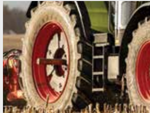
Entretoises de roue pour ajuster la voie et essieu à dégagement rapide disponibles en option.
