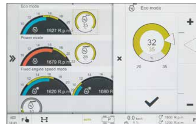
Réglage du statisme du moteur pour « Eco » et « Power », et mémoire du régime moteur.
