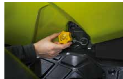
Le niveau d'huile peut être vérifié et complété lorsque le capot est fermé.
