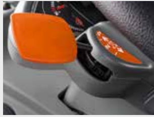
Inverseur sans embrayage REVERSHIFT avec frein de stationnement électronique disponible.
