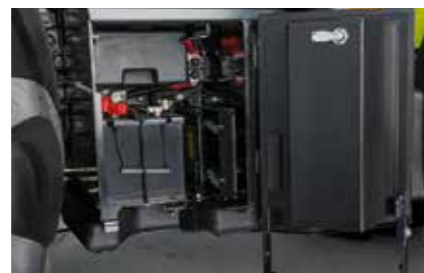
La batterie et un compartiment de rangement pour les outils sont situés dans les marches d'accès sur le côté droit.
