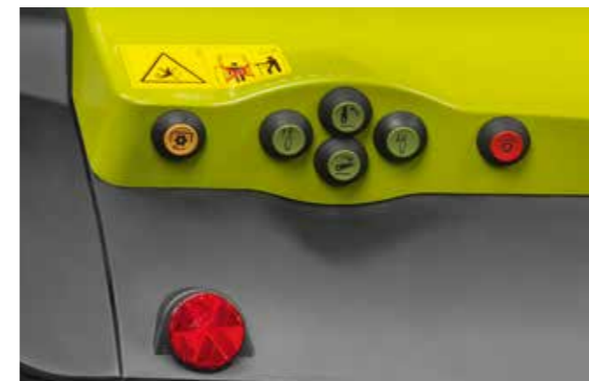
Commandes externes pour la prise de force arrière.
