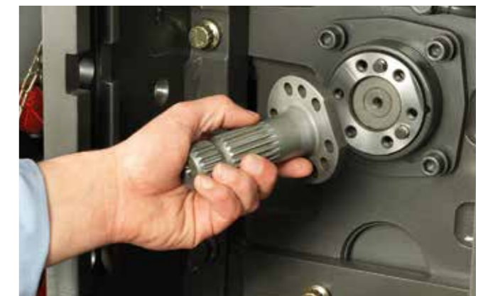
L'embout de la prise de force peut être changé facilement.
