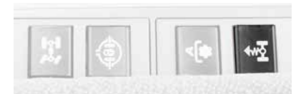
Commutateur d'activation de la suspension du pont avant.
